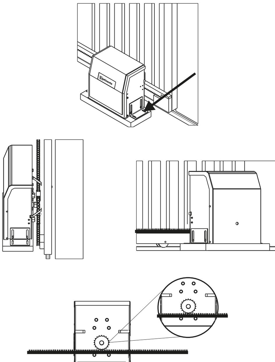
**Figura 03:** Fixar a cremalheira no portão, com um ponto de solda, observando que a engrenagem se encaixe na cremalheira, para que ocorra a movimentação do portão no momento que o movimentador for acionado.
